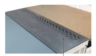
**Environnement de travail propre avec** le dispositif de récupération des copeaux positionné entre le plan de travail et le tapis de déchargement.
