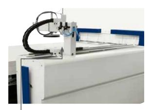
**Alignement parfait** des panneaux chargés grâce au dispositif d'alignement des pièces en entrée.
