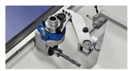
Magasin « **Pick-up** » à 1 position avec positionnement pneumatique, ancré sur la poutre mobile.
