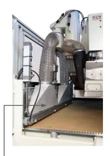
Pas des poussières avec le système d'aspiration supérieur pour le nettoyage du plan de travail.
