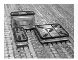
Vaste choix de ventouses MPS et MODULSET pour fixer les pièces sur le plan de travail selon les usinages à effectuer.
