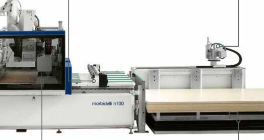
**Positionnement précis et rapide** des panneaux sur le plan de travail avec le groupe de chargement à ventouses.
