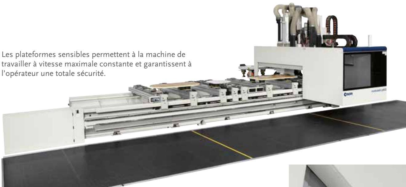
Des couches superposées de bandes latérales en protection du groupe d'usinage, mobiles pour travailler à la vitesse maximale et en totale sécurité
