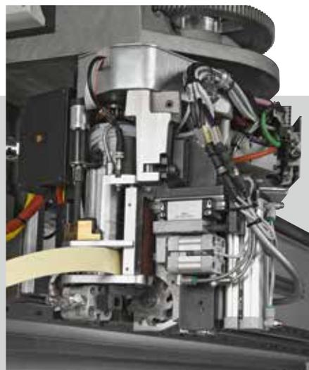
Le bac colle à changement rapide, à design exclusif avec rouleau applicateur à résistance intégrée garantit une uniformité d'encollage et la préservation des caractéristiques chimiques de la colle pour les meilleures performances du produit. La possibilité de remplacement en temps réduits permet des opérations d'entretien préventif ou de changer de type de colle (couleur ou catégorie) en réduisant drastiquement les temps morts.
