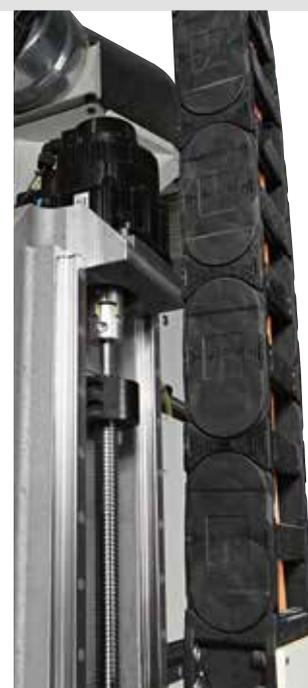
**L'axe Z à commande numérique** permet de régler le dépassement inférieur du chant par rapport à la table, par exemple pour l'utilisation de chants antipoussière.
