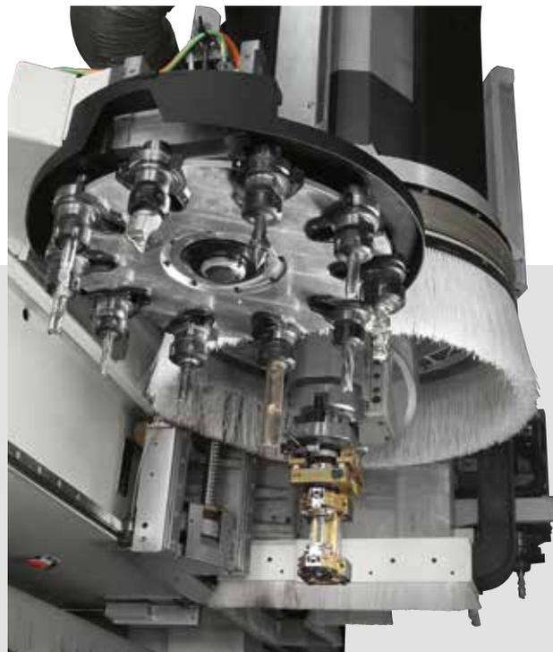
Le remplacement des outils est automatique et se fait en temps masqué, pendant que l'unité de placage de chant est en fonction, grâce aux magasins de 10 et 18 positions installés directement sur la machine.
