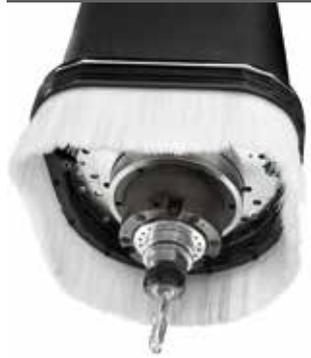
Electrobroche à 3 axes, parfaite pour exécuter des cintres du panneau ou des usinages de pare-éclat sur panneaux avec chants, en évitant de changer d'outil sur le moteur principal.
