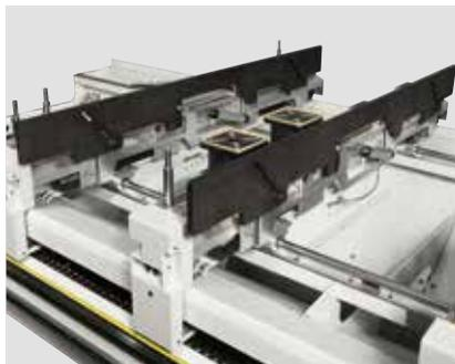
Des dispositifs d'aide au chargement pourvus de capteurs à élévation pneumatique facilitent le positionnement sur la table des panneaux lourds.
