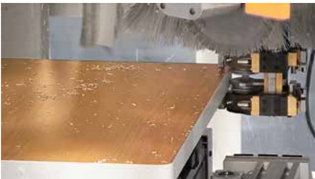
Bündigfräsbearbeitung von Kanten
