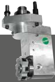
Reinigungskopf für Innenwinkel von 90° (Türen, Küchenmöbel etc.)
