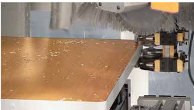
Bündigfräsbearbeitung von Kanten
