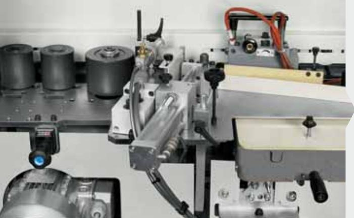
**Ottimale linea di giunzione del bordo** ottenuta con il particolare rullo che consente l'applicazione omogenea della colla in ogni materiale.
