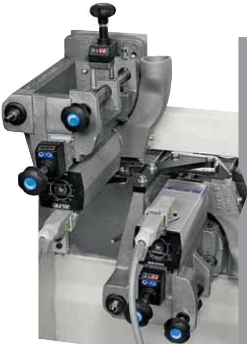
**Rapido cambio di lavorazione** tra bordo sottile, di spessore e massello con il gruppo rifilatore a 3 posizioni equipaggiato con utensili "Combi".
