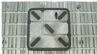
Mise au point facile de la table avec trois typologies de ventouses MPS, le système pratique à composition variable MODULSET et les butées périmétrales additionnelles à gestion électro-pneumatique
