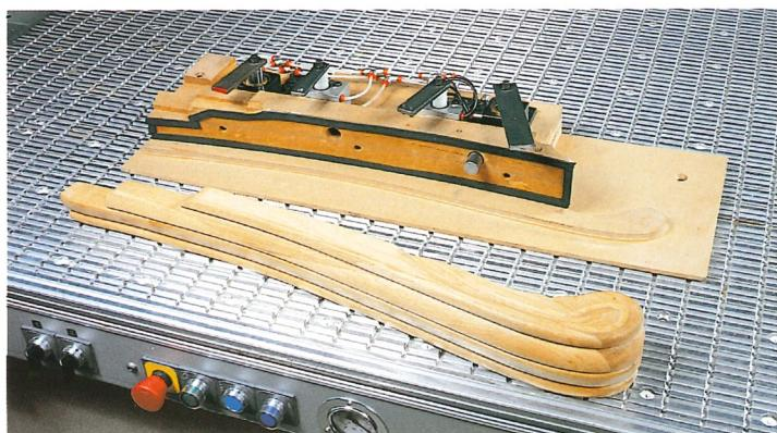
Il piano, direttamente lavorato sulla macchina, garantisce una assoluta precisione ed una perfetta planarità nel tempo, grazie alle sue caratteristiche di elevata rigidezza. Ideale anche per lavorazioni di plastica, resine e leghe leggere.
