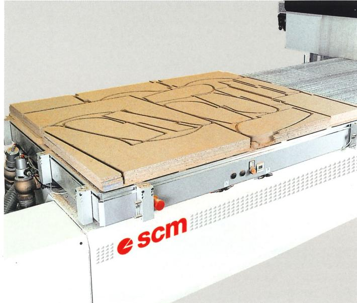
Senza limiti di tenuta. Nato per usi intensivi, il piano riesce a bloccare piu' pannelli sovrapposti aumentando la produttività.
