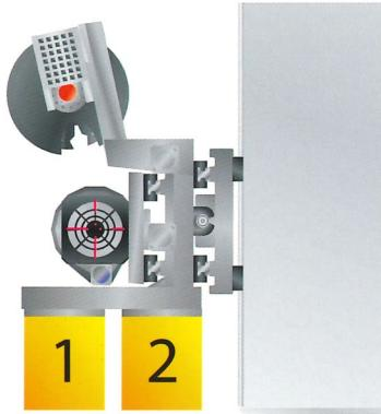
Componibile con un'intera gamma di moduli funzione, il gruppo LOGICO risolve ogni esigenza. Con il cambio utensili ON-board riduce i tempi ciclo eseguendo la sostituzione dell'utensile in tempo mascherato.
