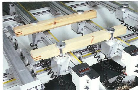
TVN SET è il sistema ideale per il posizionamento automatico delle barre, per chi produce pezzi lineari: porte, finestre, scale, travi, colonne. Estremamente semplice ed intuitivo, coniuga la flessibilità del posizionamento manuale con l'automatismo della gestione da CNC.
