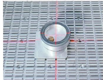
Una serie di fori filettati (passo 120 mm) offrono un'ancoraggio ideale per tutte le attrezature di bloccaggio.
