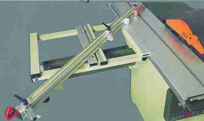
**CADRE DE GUIDAGE.** Le cadre est facilement positionnable par l'opérateur, avec sa rigidité remarquable, il garantit au guide une assise parfaite dans toutes les positions de travail.
