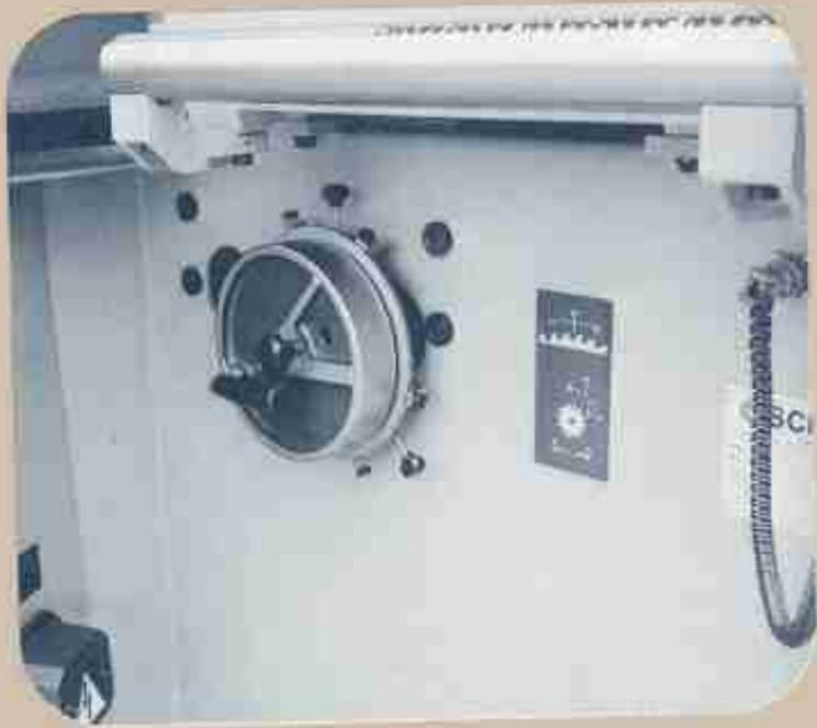
**Handrad für die Höheneinstellung des Vorritzers** (Einsatz und Fluchten mit dem Hauptsägeblatt) und Anschläge für die Einstellung.
