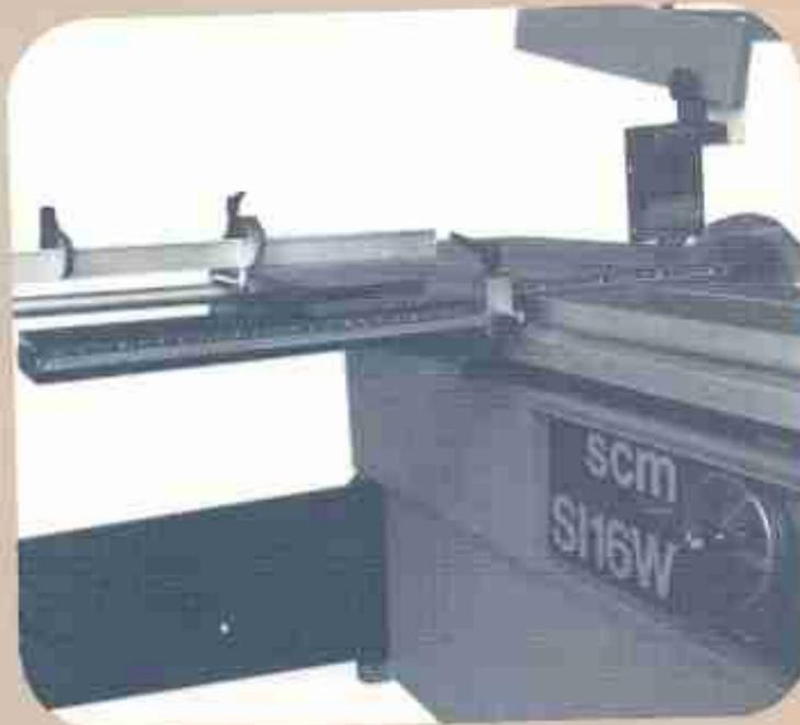
**Zusatzauflage für den Maßschnitt** auf dem Besäumwagen, einstellbar von 0-1000 mm (kann bei Nichtbenutzung abgeschwenkt werden).
