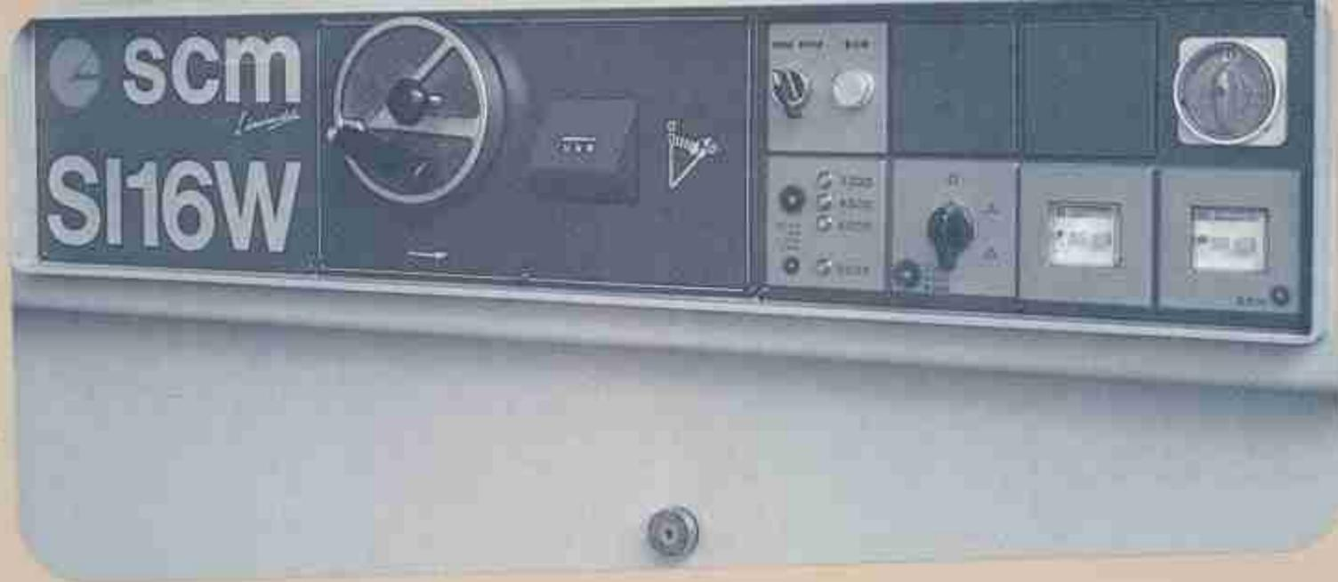
**Handrad für die Neigung des Sägeblattes mit digitaler Ablesung** der eingestellten Position.
