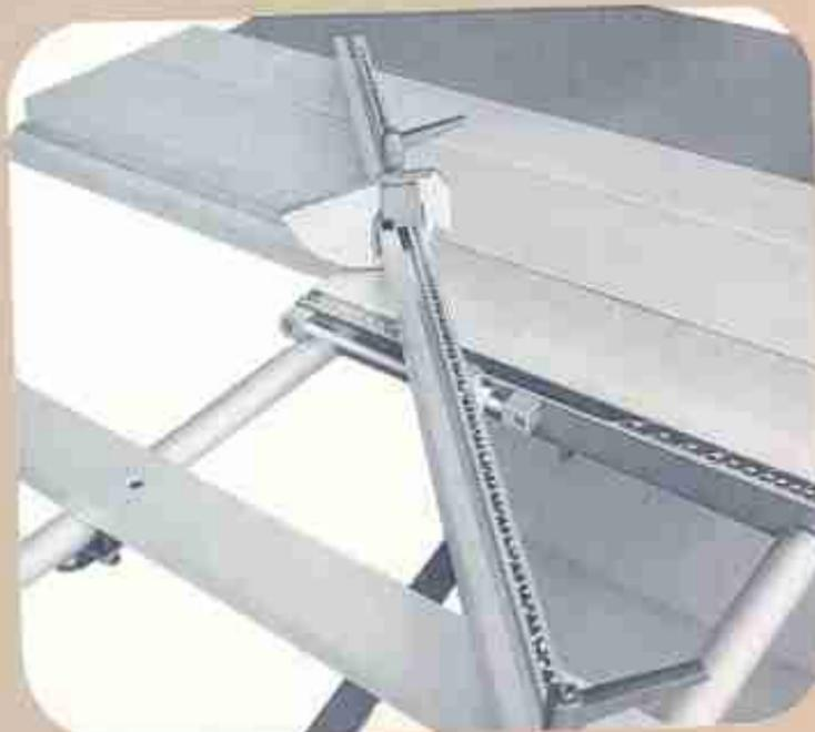
**Anschlag für Winkelschnitt** einstellbar von 0° - 45° für Schrägschnitte.
