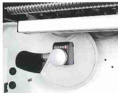
Eine spezielle, patentierte Vorrichtung erlaubt die Feineinstellung des Vorritzerhubs, der damit perfekt an die Plattenstärke angepasst werden kann.
