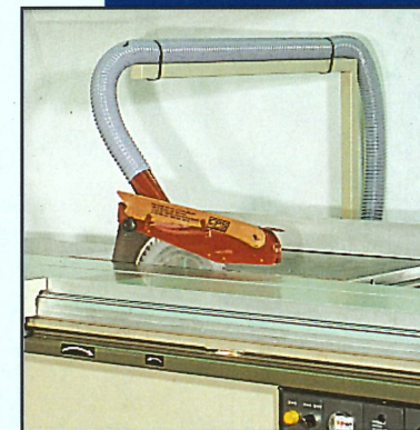
Sägeblattschutzhaube stets mit Absaugstutzen: Durchm. 60 mm für Schutz am Spaltkeil Durchm. 80 mm für Parallelogramm-Schutzhaube.
