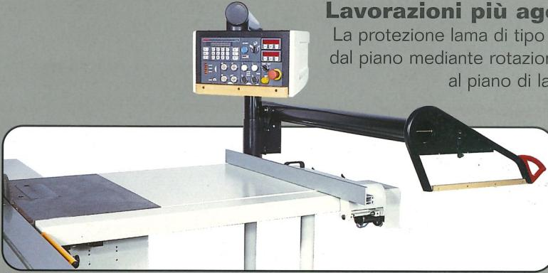
suspendida, ofrece la posibilidad de exclusión total de la mesa mediante giro del montante de apoyo. Su exclusión de la mesa de trabajo, a realizarse sólo en casos especiales, está simplificada gracias a la aspiración integrada en dicho montante. La protección de material transparente permite además, ver la pieza durante las fases de trabajo.
