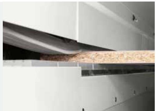
Prensor de correa ideal para tableros de superficies delicata.
