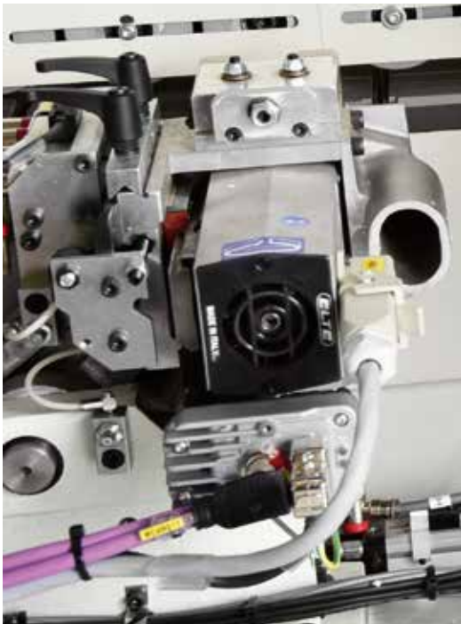
DISPOSITIVO MULTIEDGE ROUND SK Ajuste automático para el trabajos de cantos con radio y finos.
