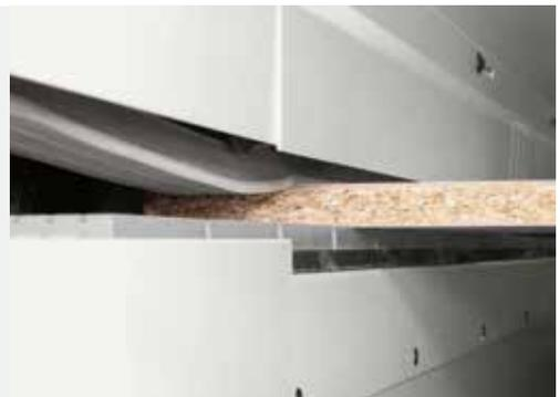
Presseur à courroie, idéal pour les panneaux à surfaces délicates.
