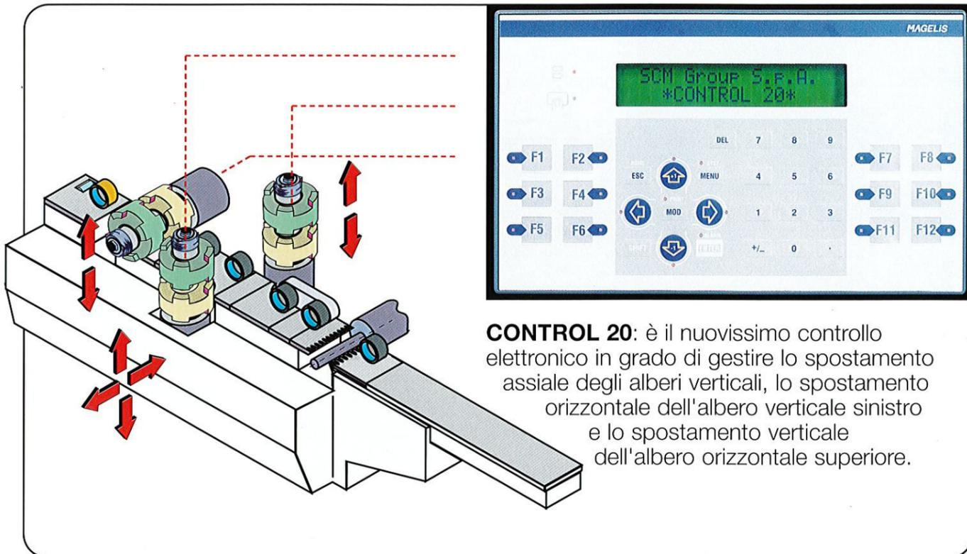
**CONTROL 20:** è il nuovissimo controllo elettronico in grado di gestire lo spostamento assiale degli alberi verticali, lo spostamento orizzontale dell'albero verticale sinistro e lo spostamento verticale dell'albero orizzontale superiore.
