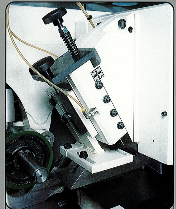
Scarpa pressatrice posta dopo l'albero orizzontale superiore a due settori.
