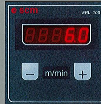
Velocità d'avanzamento fino a 36 m/min tramite inverter posto sul quadro comandi.
