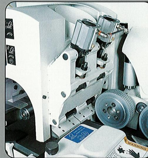
Scarpa pressatrice posta davanti all'albero orizzontale superiore con movimento inclinato e pressione pneumatica.
