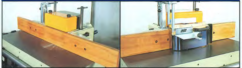
Anschlagsaufsatz aus Holz und Druckschuhe mit Schutz.
