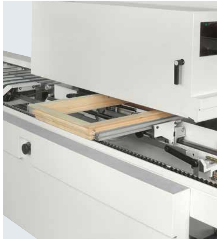
Möglichkeit einen Flügel zu umfälen auf einfache Weise, dadurch wird eine hervorragende Bearbeitungsqualität gesichert.
