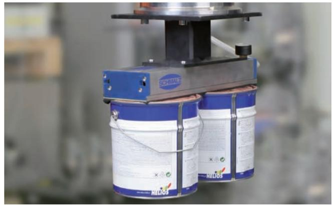
Vakuum-Flächengreifsystem FXC zur Handhabung von Eimern
