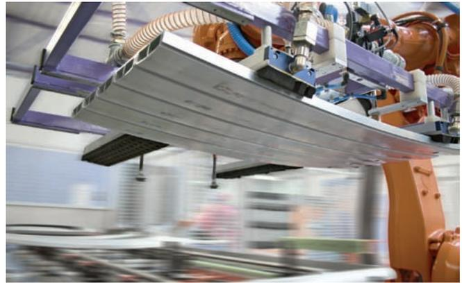
Vakuum-Flächengreifsystem FMC zur lagenweisen Handhabung von Aluminiumprofilen
