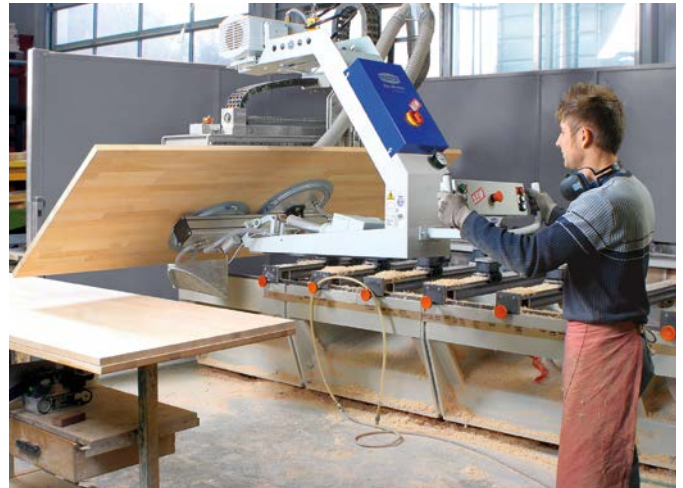
Vakuum-Hebegerät VacuMaster Comfort zum Wenden von beschichteten Holzplatten um 180°
