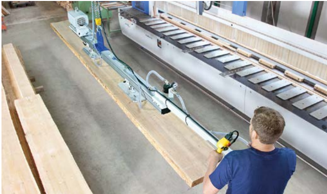
VacuMaster VHB bei der Beladung einer Längskreissäge mit Holzbrettern
