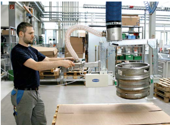
Getränke | Vakuum-Schlauchheber JumboErgo mit mechanisch-pneumatischem Greifer zum Heben und Wenden von Keg-Fässern
