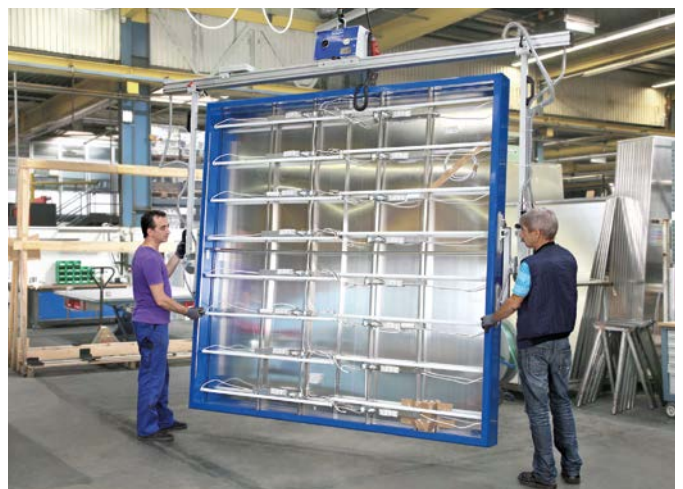
Sonderlösungen | Vakuum-Hebegerät VacuMaster Box, eingesetzt bei der Montage von großen Reklameschildern
