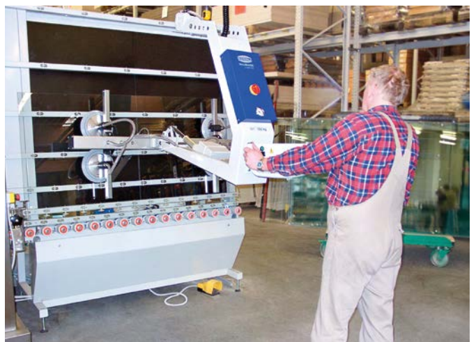
Vakuum-Hebegerät VacuMaster Comfort zum Wenden einer Glasscheibe um 180°
