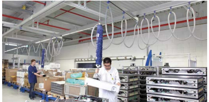
Aluminium-Krananlage SRA mit Vakuum-Schlauchheber Jumbo
