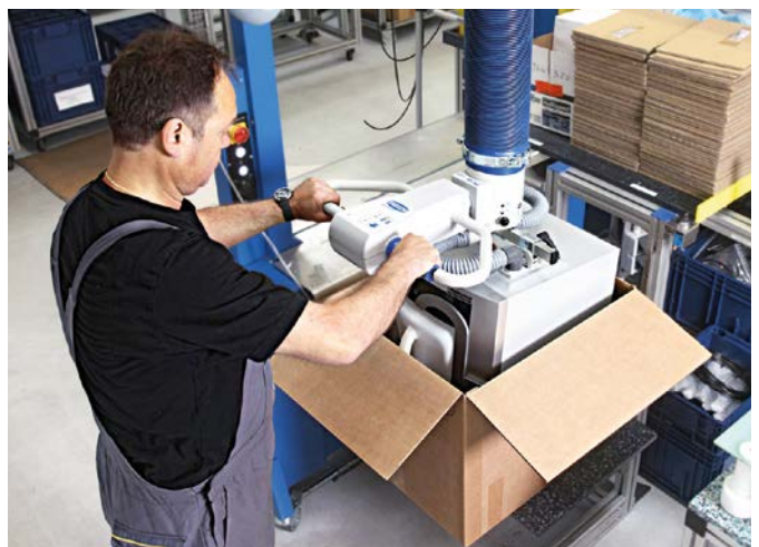
Vakuum-Schlauchheber JumboErgo zum Verpacken von Waren und zur Handhabung der Endverpackung
