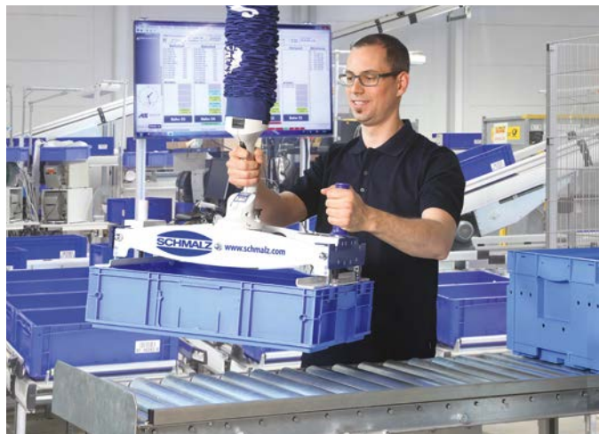
Vakuum-Schlauchheber JumboFlex zur Handhabung von Transport- und Lagerkisten
