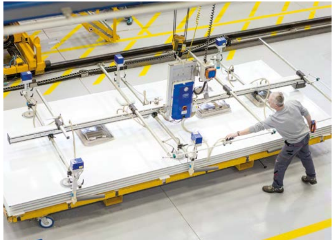
Vakuum-Hebegerät VacuMaster zur Handhabung von Dächern im Wohnwagenbau
