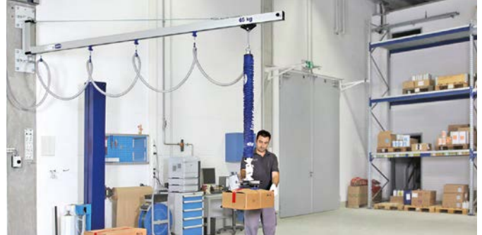
Wandschwenkkran WK mit Vakuum-Schlauchheber Jumbo
