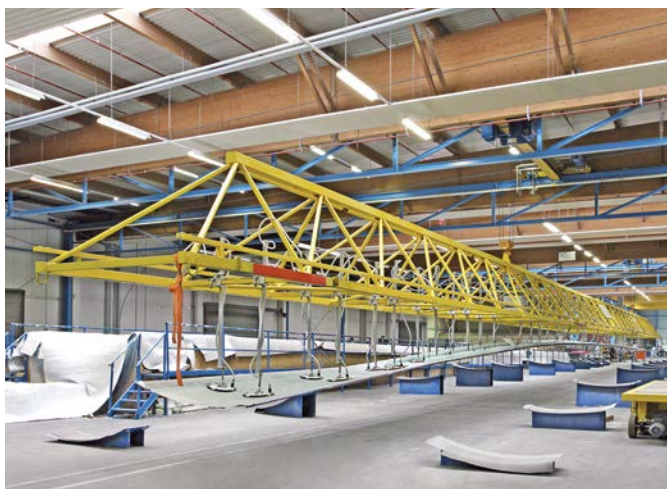
Windkraft | Vakuum-Hebegerät VacuMaster für bis zu 60 m lange und tonnenschwere GFK-Bauteile in der Rotorblattfertigung
