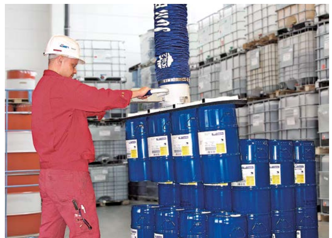
Vakuum-Schlauchheber JumboErgo mit Flächengreifer zur gleichzeitigen Handhabung von vier Fässern
