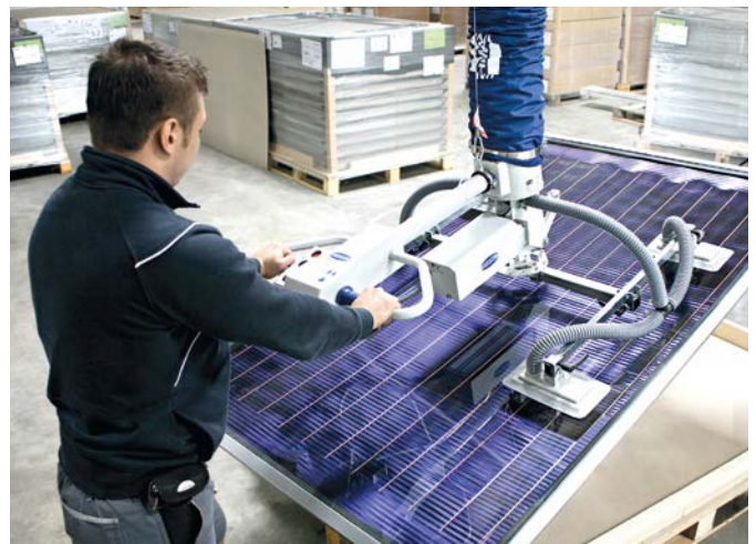
Solar | Vakuum-Schlauchheber JumboErgo, 90° schwenkbar, zur Handhabung von Solarmodulen
