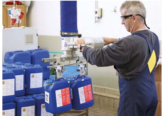
Vakuum-Schlauchheber JumboErgo mit mechanischem Greifer zur Handhabung von Kanistern
