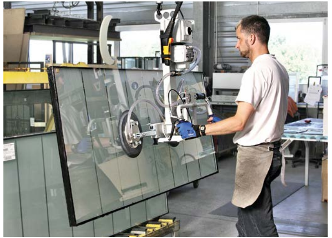
Vakuum-Hebegerät VacuMaster Window zur vertikalen Handhabung von Glaselementen
