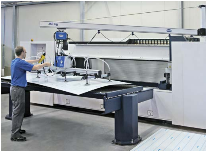
Vakuum-Hebegerät VacuMaster Basic zum Be- und Entladen einer Laserschneidanlage
