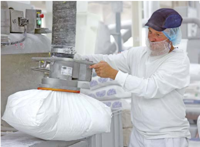
Vakuum-Schlauchheber JumboSprint Ex zur Handhabung von Säcken im Ex-Schutz-Bereich
