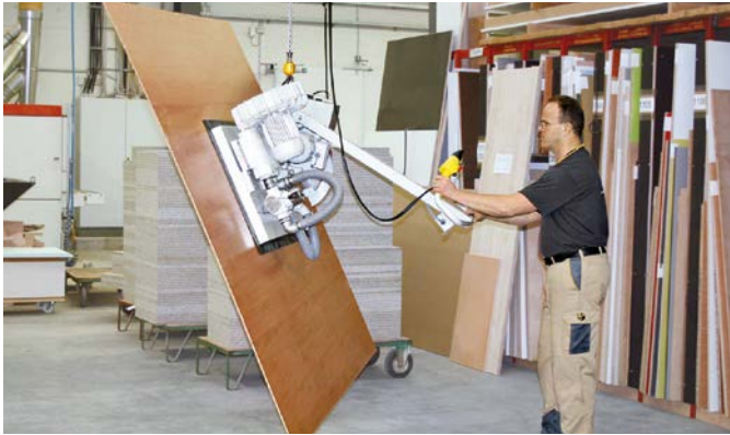
VacuMaster Multi zum Schwenken von Holzplatten um 90°
