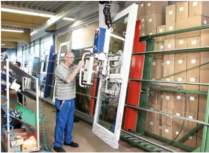
Vakuum-Hebegerät VacuMaster Window Comfort zur vertikalen Handhabung eines mehrflügeligen Fensters
