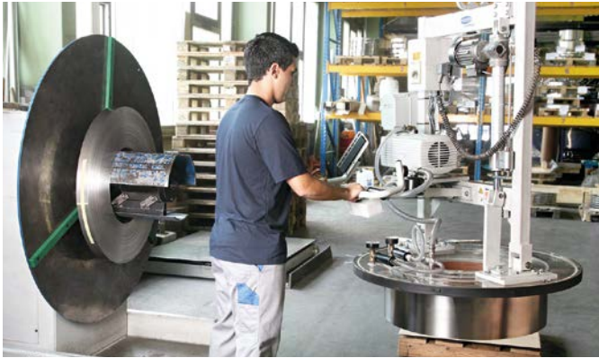
VacuMaster Coil zum Schwenken von Edelstahl-Coils um 90°
