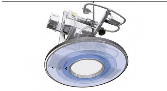
Saugplatte mit drei getrennten Vakuum-Kammern
