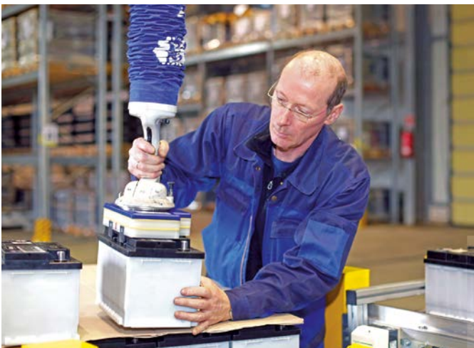
Vakuum-Schlauchheber JumboFlex Battery zur Handhabung von Batterien
