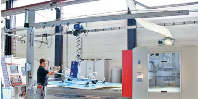
Säulenschwenkkran SK mit Kettenzug und Vakuum-Hebegerät VacuMaster
