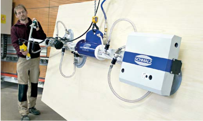
VacuMaster HHVM zur Entnahme von Holzplatten aus stehenden Lagern
