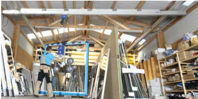
Aluminium-Krananlage SRA mit Kettenzug und Vakuum-Hebegerät VacuMaster
