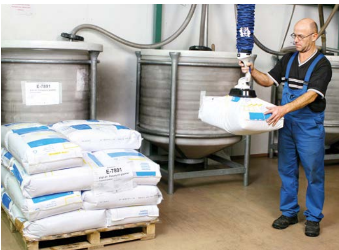
Vakuum-Schlauchheber JumboFlex zur Palettierung von Kunststoffsäcken
