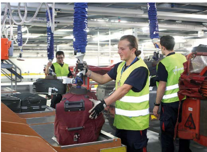
Vakuum-Schlauchheber JumboFlex zur Handhabung von Gepäckstücken am Flughafen
