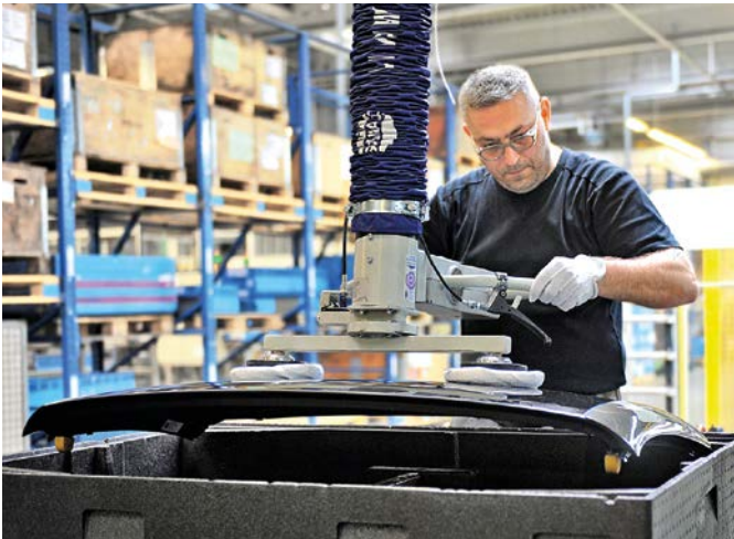
Vakuum-Schlauchheber JumboErgo zur Handhabung von Karosseriebauteilen
