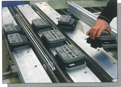
Vakuum-Aufspannsysteme VC-K1 und VC-K2 für Konsolen mit 1- bzw 2-Kreis-System
