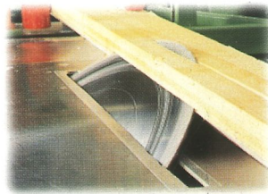
Neigbare Schmidler Untertisch-Schwenkkappsäge. Patentiert!
