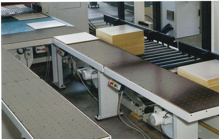
**Soluzione di scarico semi-automatico con tavole idrauliche.**
