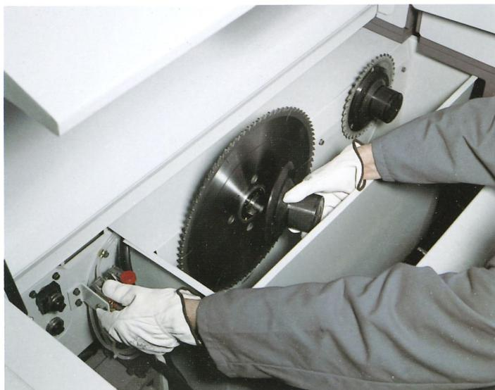
La sostituzione estremamente rapida e sicura delle lame viene eseguita con il sistema Selco 'Quick change' protetto da un brevetto internazionale.
