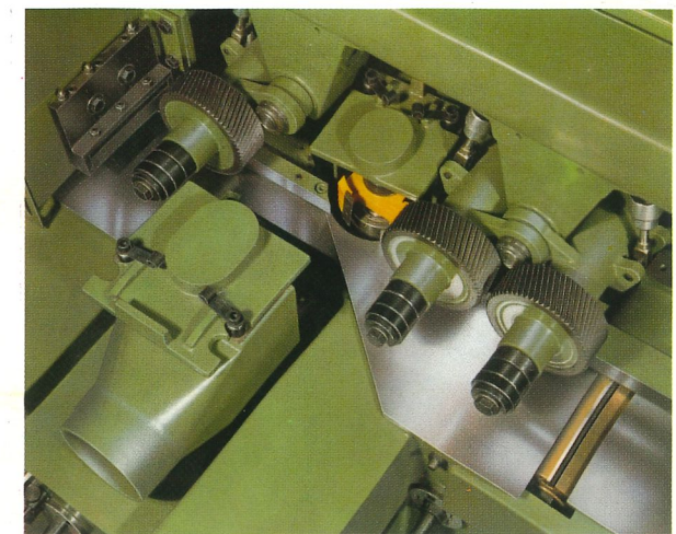
PARTICOLARE RULLI DENTATI PER L'AVANZAMENTO CON EVIDENZIATA PRESSIONE PNEUMATICA (A RICHIESTA) DETAIL GALETS DENTÉ D'ENTRAÎNEMENT À BOIS ET SYSTÈME PRESSION PNEUMATIQUE (SUR DEMANDE) VIEW OF THE SERRATED FEED ROLLERS AND PNEUMATIC PRESSURE BAR SYSTEM (BY REQUEST) VORSCHURÖLLEN - ANSICHT UND PNEUMATISCHE DRUCKSYSTEM DER TRAVERSE (AUF VERLANGE)
