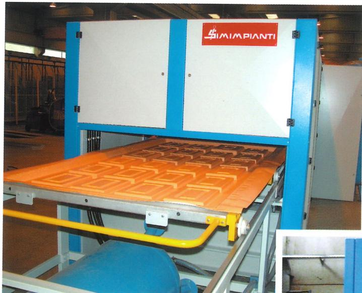
Il modello Flexipress viene fornito in versione standard con un vassoio.
