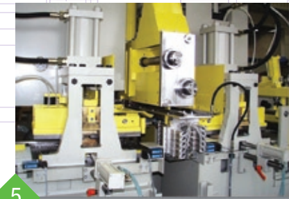
Zweiseitiger, berührungsloser PUR-Klebstoffauftrag Bothside touchless PUR-applicator with double nozzle head
