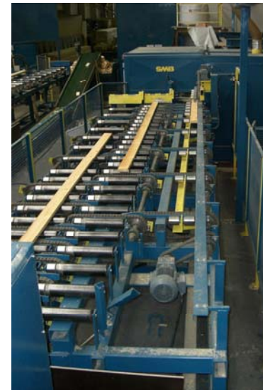
Fräs - Pressen Kombination mit berührungsloser Leimangabe Type - GFP
