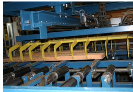
Fräs - Pressen Kombination mit berührungsloser Leimangabe Type - GFP
