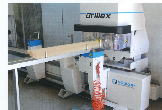
Čelní vrtání příček a sloupků Head drilling of bars and mullions
