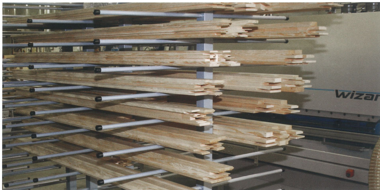
Plné opracování jednotlivých elementů pro dílcovou metodu výroby oken Full manufacturing of single elements for knock-down windows production
