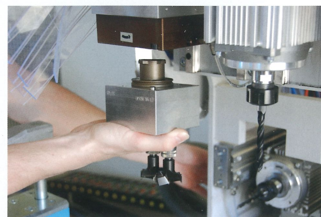
Výměnné vrtací hlavy pro kliku a závěsy Exchangeable drilling heads for handle and hinges
