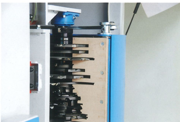
Protivyštípávací přítlak při čepování Chip breaking device for tenoning
