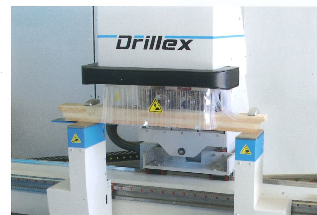
Podélné vrtání Longitudinal drilling
