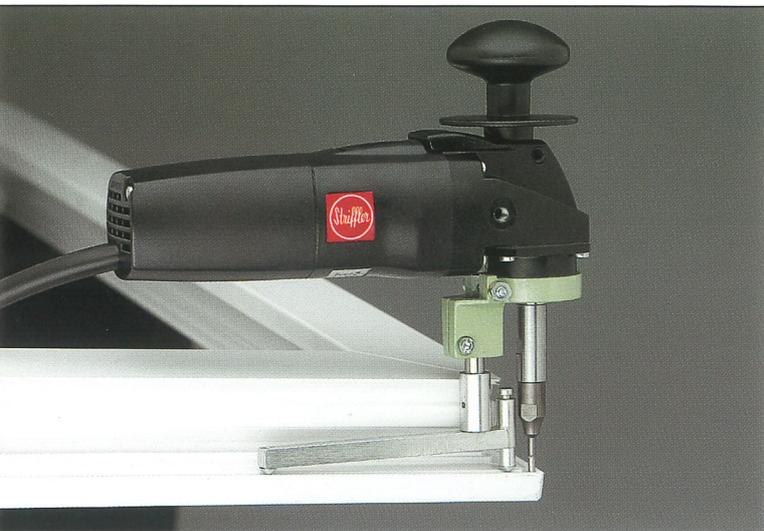
Dichtungsnut - Fräse **634**, mit Hilfe einer um 15° schwenkbaren Führung können Profilmuten ohne Umstellung von Schweißraupenresten gesäubert werden.
