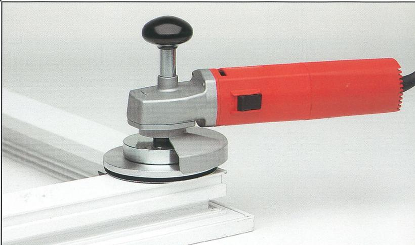
Poliermaschine **646** poliert geschliffene und verkratzte Kunststoff- und Aluprofile in Ihrer Struktur und Ihrem Glanz ähnlich der unbearbeiteten Profiloberfläche, fein matt.
