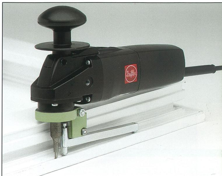
Beschlageinfräsgerät **631** zum Fräsen von Nuten, Schlitzen, Aussparungen. Die Führung ist mit oder ohne Deckplatte links oder rechts, vor oder hinter dem Fräser und beliebig in Höhe und Breite zu diesem einstellbar.
