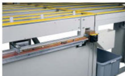
Beschlagstanze mit Stanzlängenanschlag
