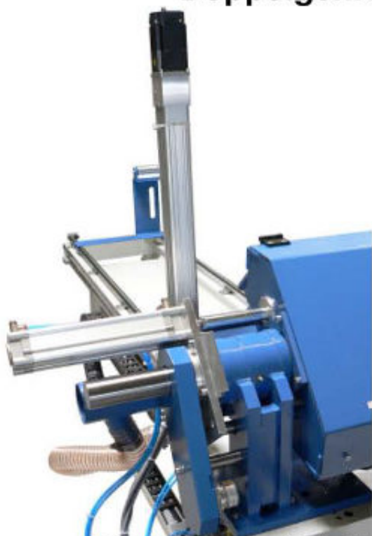
Sonderausführung der Schwengung mit zus. Drehgeber
