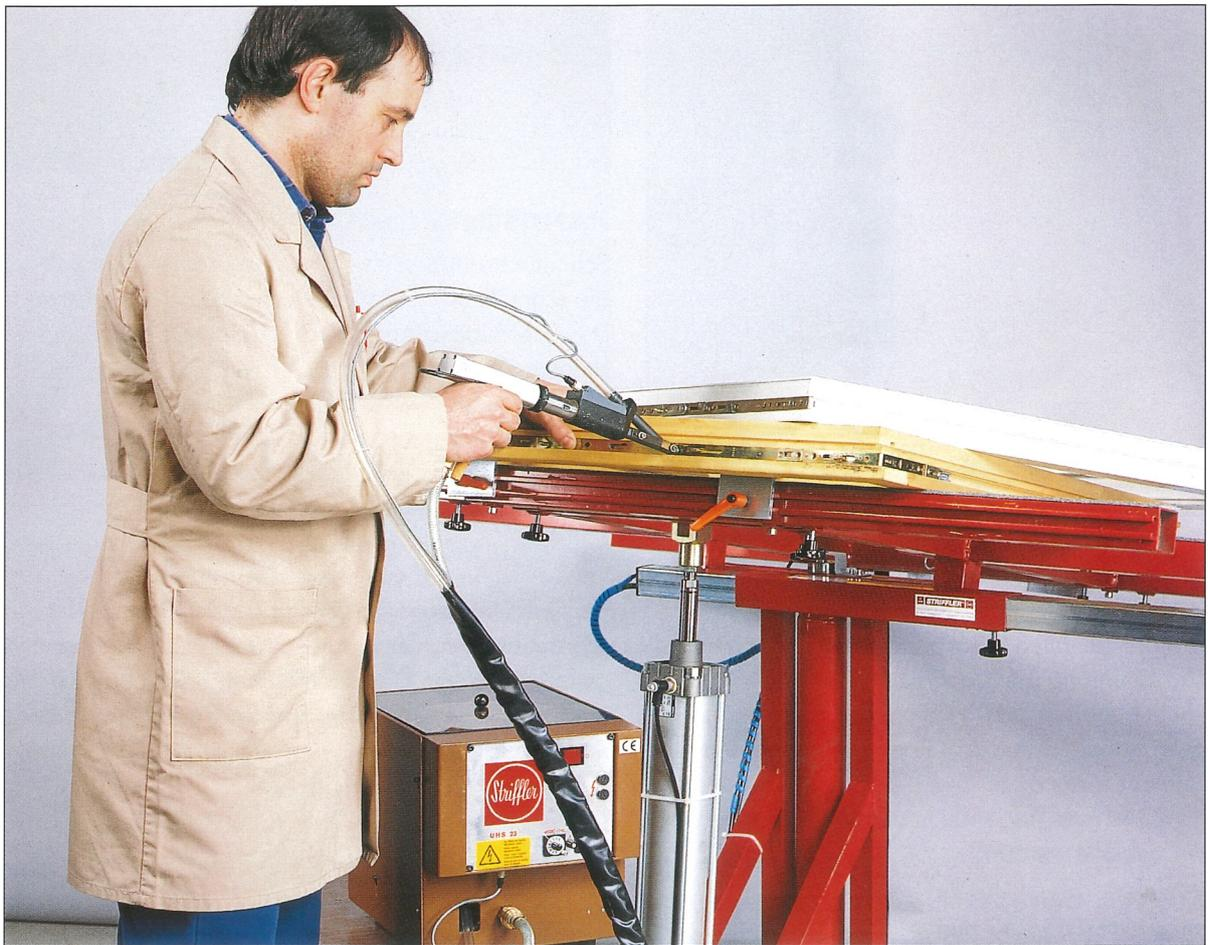
PISTOLEN-HANDSCHRAUBER MIT AUTOMATISCHER SCHRAUBEN-ZUFÜHRUNG UHS 23
