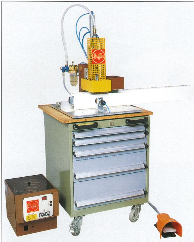
Tisch-Schraubgerät 2954 mit automatischer Schraubenzuführung UHS 23.
