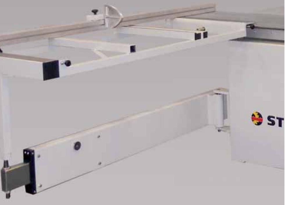
Der Alu-Wagen ist eloxiert und läuft auf prismatischen Stahlführungen mit gehärteten Kugelrollen zur Garantie von Genauigkeit und Dauerhaftigkeit.
