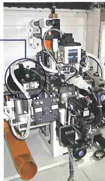
Multifunctional fine trimming unit Groupe d'affleurage de définition multifonction Vielfaches Fase- und Radiusfräsaggregat
