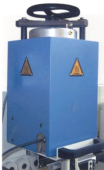
Kit applicazione colla poliuretànica (PUR) PUR glue process device Kit aplicaciòn cola poliuretànica (PUR)
