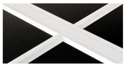
Auf dem Profilleistenbearbeitungszentrum GLS werden die Sprossen von der 6m Stange weg passgenau schräg abgelängt und je nach Programm auch gebohrt. Anschließend wird an den Enden auf der Clipfräse CF die Ausfräsung für den Clip ausgeführt und der Clip wird automatisch zugeführt und eingepresst. Für die Kreuzverbindung wird auf der Dübeleintreibmaschine DEM der Alu Dübel in die Sprosse eingesetzt.
