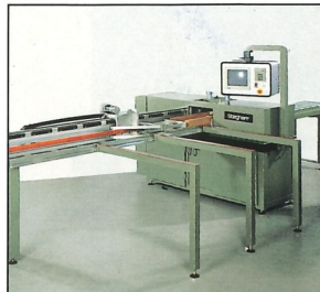
Doppelseitige Dübelbohrmaschine DD Double-sided dowelling machine DD Dubbelzijdige deuvellboormachine DD
