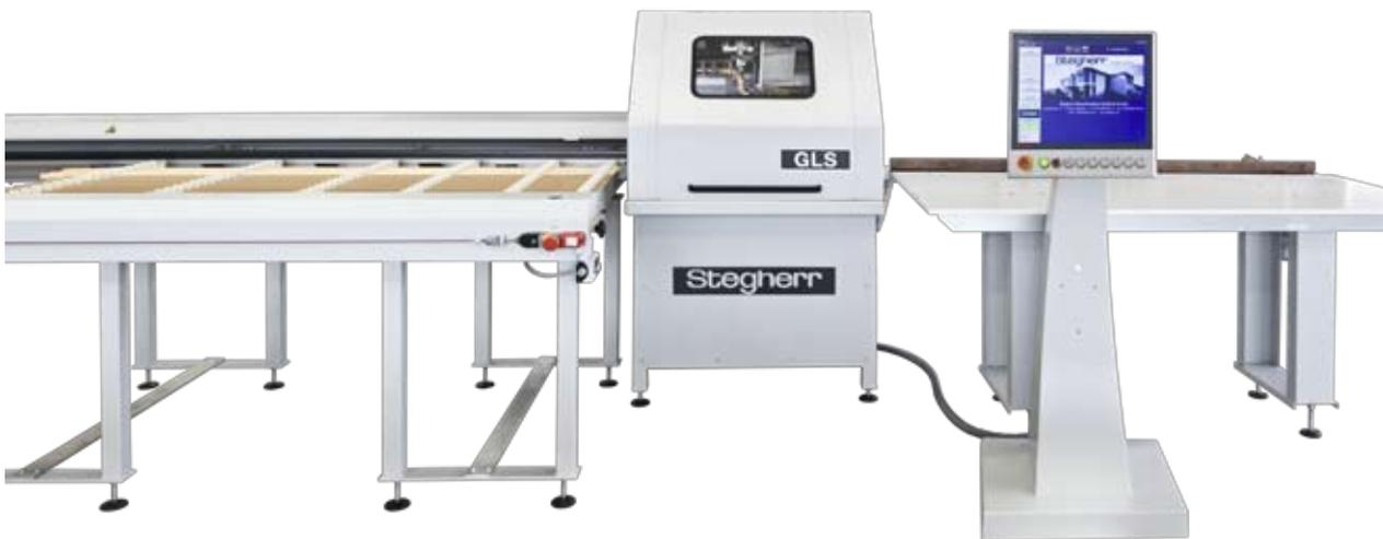
Mit der Profilleistensäge Stegherr Type GLS können Glasleisten, Türprofilleisten, Regenschutzschienen oder andere Profile aus Holz, Aluminium, MDF oder PVC nach Programm innerhalb +/- 45 Grad in einer Ebene abgelängt werden.
