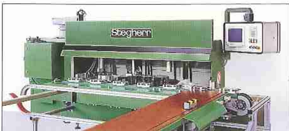
Sprossenbearbeitungszentrum SBZ Sash processing center SBZ
