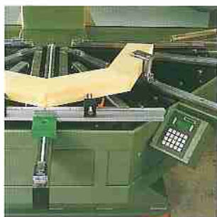
Sekundenschnelles Zentrieren jedes beliebigen Werkstückes durch den Hilfsanschlag mit Eingabe des abgelesenen Wertes in die Tastatur
