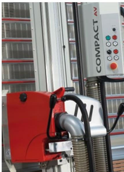
„Clásico y consagrado“ diseño Striebig: grupo de serrado y caja de mando de COMPACT AV. La facilidad de manejo forma parte desde siempre del sello de Striebig.
