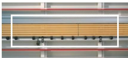
Soporte central continuo y soporte para piezas pequeñas en toda la longitud, mayor confort al serrar piezas de menor tamaño. De serie: soporte central de tramas de aluminio resistente. Opcional: trama de gama alta de materiales sintéticos, para tableros de recubrimientos especialmente exigentes.
