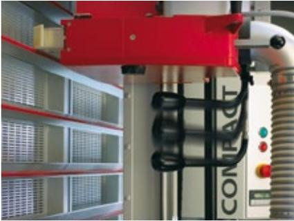
Grupo de serrado con un motor más potente, con gran fuerza de arranque (3,9 kW) y una palanca de manejo ajustable (facilita el desplazamiento del grupo de serrado).
