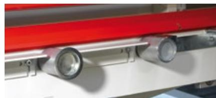
COMPACT AV, rodillos de apoyo con freno neumático de serie. COMPACT, rodillos de apoyo con freno mecánico opcionales.
