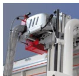
El dispositivo de posicionamiento de trabajo (gancho de retención mecánico disponible para el funcionamiento también con el montaje de una limitación de la altura de corte) permite el desplazamiento a la posición de trabajo seguro del grupo de sierra en trabajos en altura.
