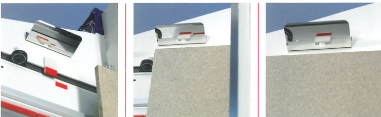
Der Spiegel am Sägebalken erleichtert die Orientierung beim vertikalen Schnittpunkt (wichtig bei grösseren und überstehenden Plattenformaten).
