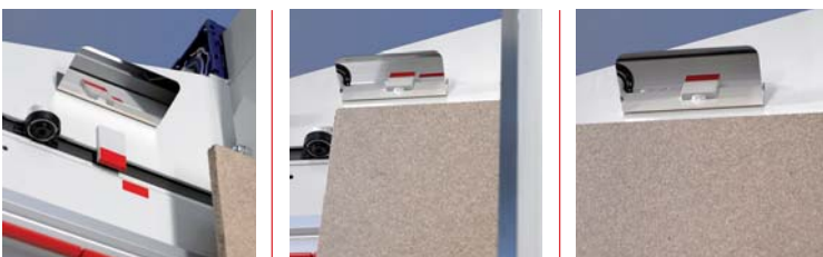
El espejo de la barra de la sierra facilita la orientación en el punto de corte vertical (importante en el caso de formatos de tableros grandes y en posición elevada).
