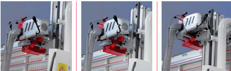
El dispositivo de inmersión (gancho de retención mecánico) permite la inmersión segura del grupo de sierra en trabajos en altura.
