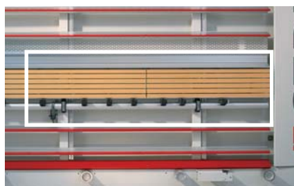
L'appoggio centrale e l'appoggio per pezzi piccoli su tutta la lunghezza, permettono di aumentare il comfort durante il taglio di pezzi piccoli. Serie: l'appoggio centrale è composto da robuste camme d'alluminio. Opzione: camme high-end in materiali sintetici per rivestimenti dei pannelli particolarmente delicati.
