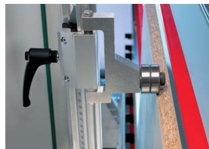
Battuta a strisce in lunghezze da 400 e 600 mm con appoggio a rulli per non ferire i bordi del pannello.
