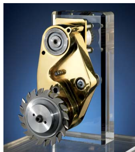
Aggregato di preintagliatura VSA con lama regolabile senza soluzione di continuità. Impedisce efficacemente lo strappo dei bordi. Permette di ottenere risparmi di tempo, di costi e per gli utensili. In caso di livello di qualità eventualmente ridotto dei pannelli stratificati, a nostro parere il VSA è un obbligo!
