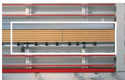
Durchgehende Mittel- und Kleinteileauflage auf der gesamten Länge für erhöhten Komfort beim Sägen kleiner Teile. Serie: Mittelaufgabe aus widerstandsfähigen Alu-Rastern. Option: High-End-Raster aus synthetischen Werkstoffen für besonders anspruchsvolle Plattenbeschichtungen.
