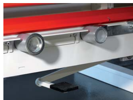
COMPACT AV – pneumatisch gebremste Auflagerollen serienmässig. COMPACT – mechanisch gebremste Auflagerollen optional.
