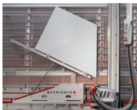
Das Winkelschnittgerät WSG hält das einmal eingestellte Mass in allen Winkeleinstellungen exakt.
