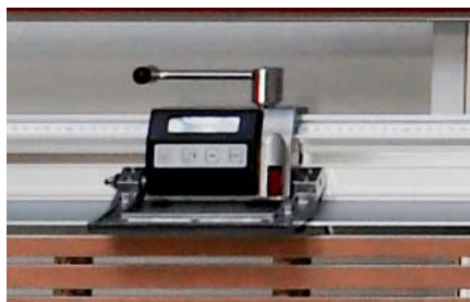
Digitales Mess-System DMS – auf 1/10mm genau messen.
