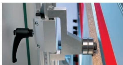
Butée à liteaux en 400 et 600mm de longueur avec rouleaux d'appui protégeant les arêtes.
