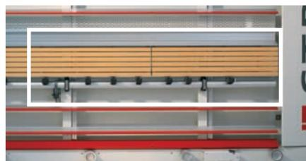
Appui intermédiaires et appui pour petites pièces (longueur totale rallongée) pour un meilleur confort de coupe des pièces de petite taille. Appui intermédiaire de rouleaux en aluminium résistant. Pattes d'appui high-end en matières synthétiques pour des revêtements de panneaux exigeants (en option).
