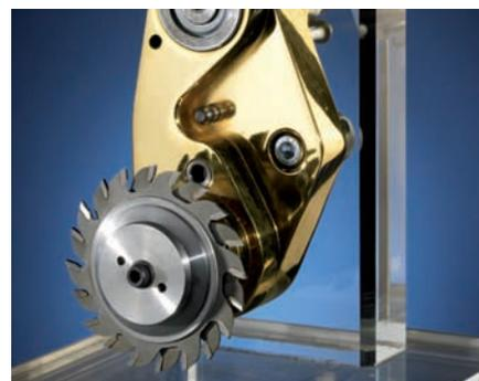
Le dispositif inciseur VSA avec lame de scie librement réglable. Il empêche de façon sûre le déchirement des arêtes. Il permet des économies de temps, de frais et de coûts d'outillage. Dans le cas de panneaux à revêtements de petite qualité, nous considérons le groupe VSA comme indispensable !
