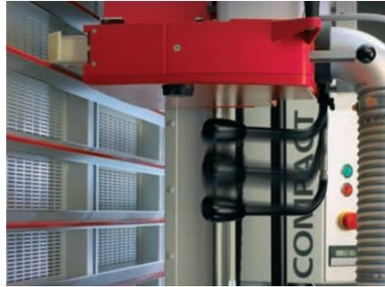
Groupe de sciage avec moteur d'avance puissant (3,9 kW) et levier de commande télescopique de scie, qui facilite grandement la plongée du groupe de sciage.
