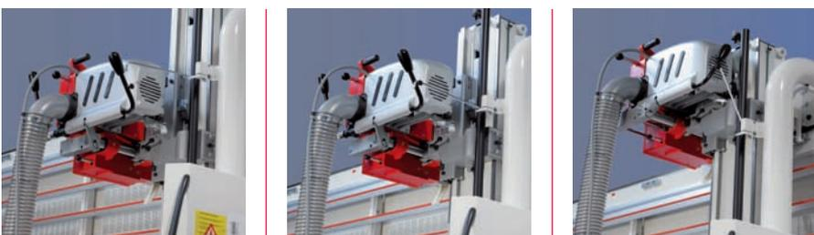
Le dispositif de plongée (crochet de retenue mécanique) facilite la plongée en toute sécurité du groupe de sciage dans la partie haute du panneau.
