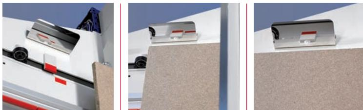
O espelho na barra de serra facilita a orientação no ponto de corte vertical (importante no caso de formatos de painéis de dimensões superiores e acima da altura da cabeça).
