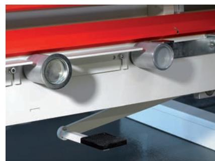
COMPACT AV – rolamentos de apoio travados pneumaticamente de série.
