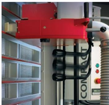
Unidade de serra com motor potente (3,9 kW) e alavanca de operação de comprimento ajustável (facilita a introdução da unidade).
