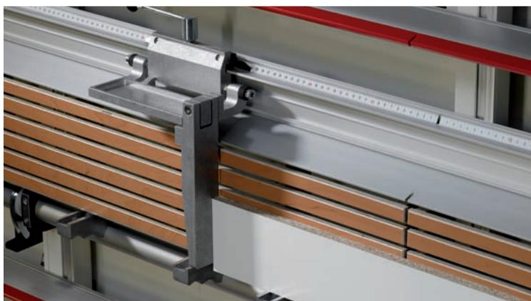
O suporte intermédio e o apoio de pequenas peças a todo o comprimento oferecem mais conforto ao cortar peças mais pequenas. O suporte intermédio é feito de apoios em alumínio resistentes. Opcional para coberturas de painéis exigentes: Peças de apoio "High-End" de material sintético.
