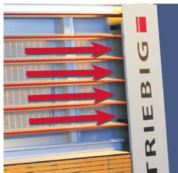
Aspiração TRK integrada especialmente potente. Valor-limite de pó claramente abaixo de 1 mg/m<sup>3</sup>.
