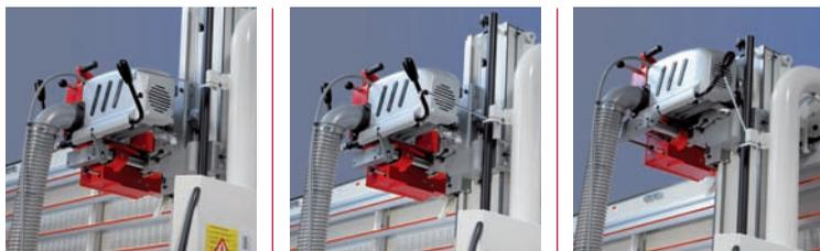
O dispositivo de introdução (gancho de retenção mecânico) permite a introdução segura da unidade de serra na área acima da altura da cabeça.
