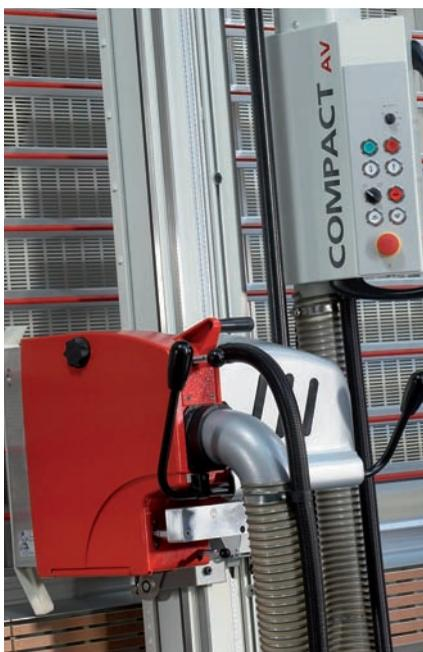
Design Striebig "clássico e consagrado": Unidade de serra e caixa de comando da COMPACT AV. A facilidade de manuseamento faz parte, desde sempre, da imagem de marca da Striebig.
