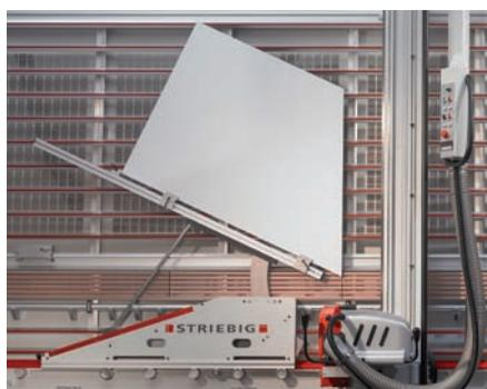
A máquina de corte angular WSG conserva de forma exacta a medida definida uma vez em todos os ângulos.
