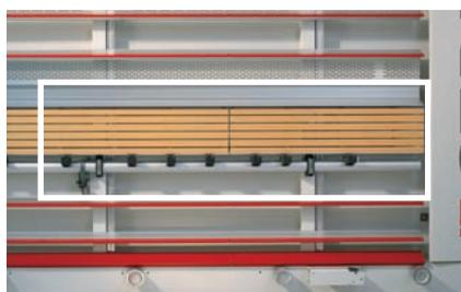
Suporte intermédio e apoio de pequenas peças a todo o comprimento para maior conforto ao cortar peças mais pequenas. De série: suporte intermédio feito de apoios em alumínio resistentes. Opção: peças de apoio "High-End" de materiais sintéticos para coberturas de painéis especialmente exigentes.
