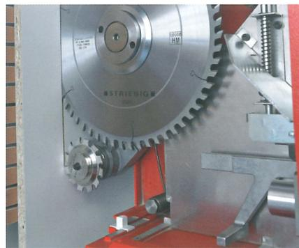
Zeit-, kosten- und werkzeugsparend – die Vorteile des Vorritzsägeaggregates VSA. Bei grösseren Mengen und einem evtl. niedrigen Qualitätsniveau der Platten ist das VSA ein „Muss“. Denn: Die Standzeit eines Hauptsägeblattes verlängert sich um das 7-8fache. Ein Vorritz-Sägeblatt übersteht mind. 3 Hauptsägeblätter.
