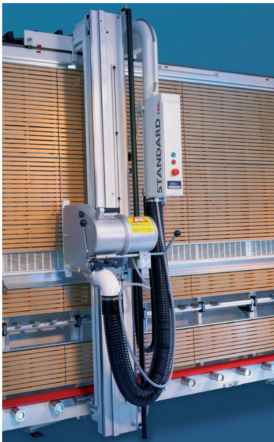
Ergonomia funcional: Barra e caixa de comando da STANDARD. O bloqueio duplo da barra de serra proporciona uma precisão absoluta de ângulo
