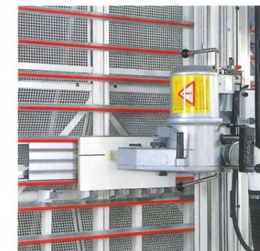
Schnitt auf der Mittelauflage mit Kleinteileauflage
