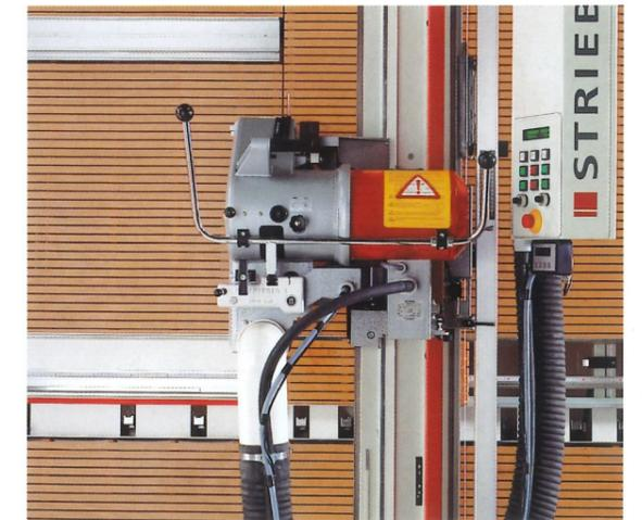
Die neue Drehstange der dritten Generation, mit den Rasterstellungen neutral, Vertikalschnitt und Horizontalschnitt.
