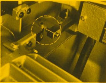
Der STRIEBIG-AUTOMAT ist so konstruiert, daß die Maschine – aus welchen Gründen auch immer – mit einem Handgriff auf manuelle Bedienung umgestellt werden kann, ohne daß dabei der Automatik-Antrieb mitbewegt werden muß.
