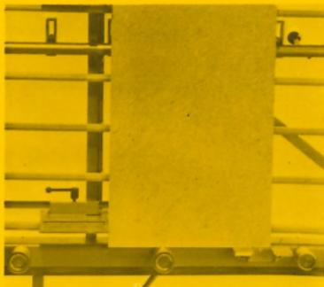
● Die 15 robusten, kugelgelagerten Auflagerollen sowie die stabile Nullpunktauflage sind auf 1/100 mm parallel zur oberen Führungsschiene geschliffen. Diese Rollen weisen zusätzlich folgende Vorteile auf:
