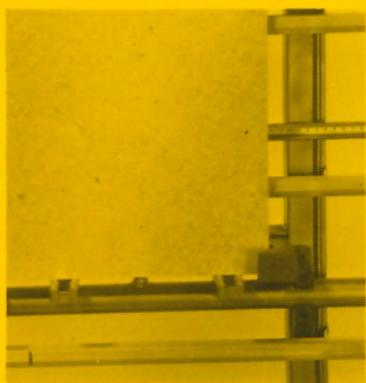
● Die 470 cm lange, stabile Mittelaufgabe ist 13-fach gelagert und ermöglicht den Zuschnitt auf bequemer Arbeitshöhe. Die 24 Raster der Mittelaufgabe weisen Aussparungen auf, damit die Sägeabfälle nicht auf der Werkstückauflage liegenbleiben, sondern zu Boden fallen. Die engen Abstände verhindern auch hier ein Abkippen des Werkstückes.
