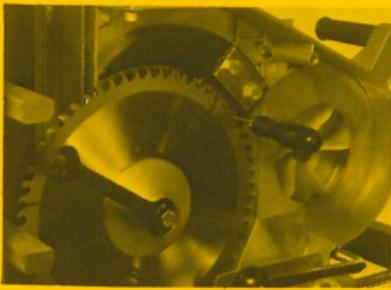
● Das Marken-Hartmetallsägeblatt ( $\phi$  300 mm) garantiert hohe Schnittleistung/-qualität sowie lange Standzeit und fällt durch einen sehr geringen Geräuschpegel auf.
