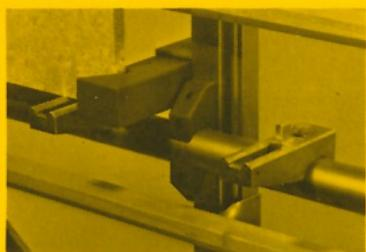
● Ausziehbare Halteklötze über der Mittelaufgabe sichern kleine und schmale Werkstücke vor dem Wegrutschen beim Waagrechtsschnitt.
