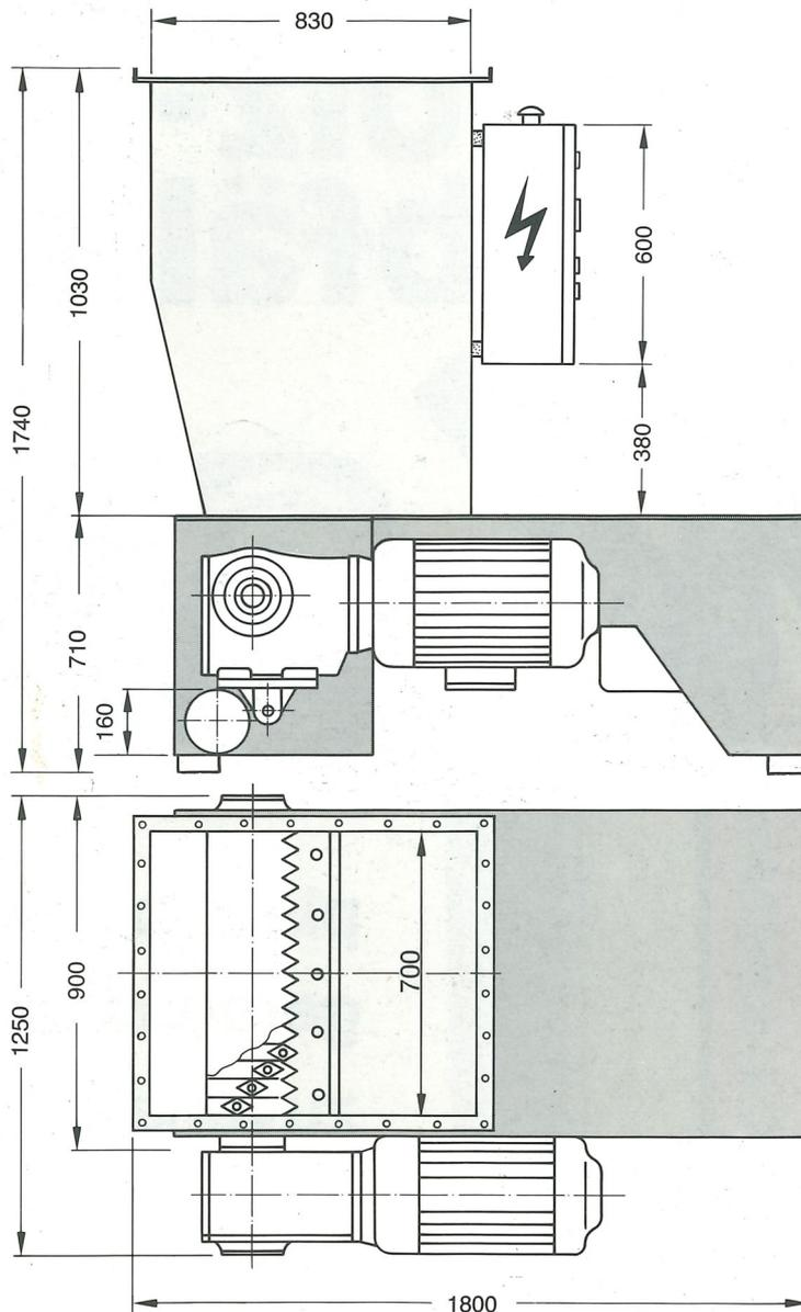
Durch den Schuko-Zerkleinerer wird mit geringem Kraftbedarf und geräuscharmen Lauf ein homogenes Schnittgut erreicht. Je nach Sieblochung kann das Material zum Brikettieren oder Heizen verwendet werden.
